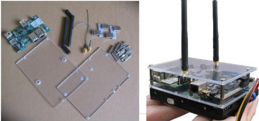
A sinistra, il KIT\_H, che permette di realizzare la CiaB “orizzontale”, con PremoBoard e CubieBoard connesse fianco-a-fianco, alle quali è possibile aggiungere opzionalmente in disco da 3.5” come si vede a destra
